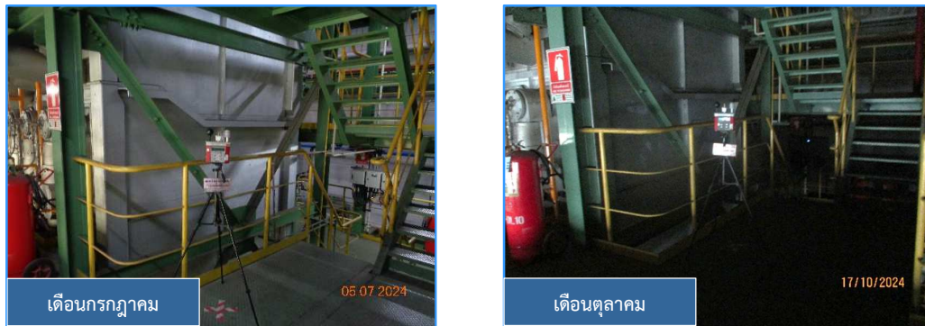
ภาพที่ 3.48 การตรวจวัดความร้อนในสถานที่ทำงานบริเวณเครื่องอบให้ความร้อน (Annealing Heater)
