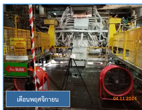
ภาพที่ 3.40 การตรวจวัดระดับเสียงในสถานที่ทำงานบริเวณ Gas wiping unit
