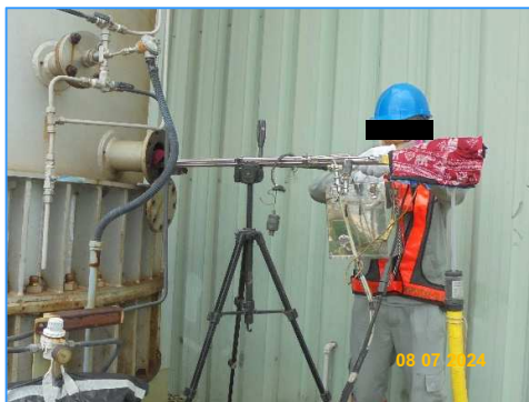
ภาพที่ 3.9 การตรวจวัดก๊าซออกไซด์ของไนโตรเจน ( \text{NO}_x ) จากแหล่งกำเนิด
