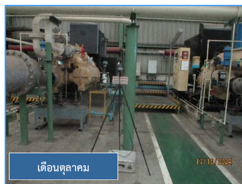
ภาพที่ 3.43 การตรวจวัดระดับเสียงในสถานที่ทำงานบริเวณ Air compressor
