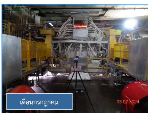
ภาพที่ 3.40 การตรวจวัดระดับเสียงในสถานที่ทำงานบริเวณ Gas wiping unit
