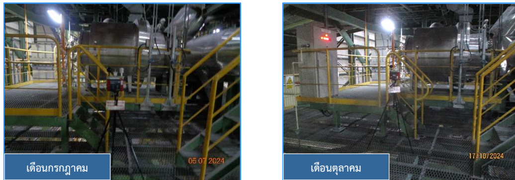
ภาพที่ 3.49 การตรวจวัดความร้อนในสถานที่ทำงานบริเวณเครื่องอบให้ความร้อนชุบเคลือบ (Galvanealing Heater Process)
