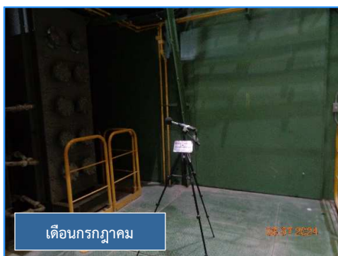
ภาพที่ 3.41 การตรวจวัดระดับเสียงในสถานที่ทำงานบริเวณ Water quench dryer
